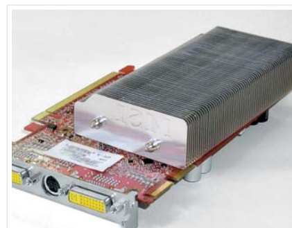
MSI RX1650XT-T2D256EZ Система охлаждения лидера теста также весьма массивна, хотя и проще, чем у ASUS
