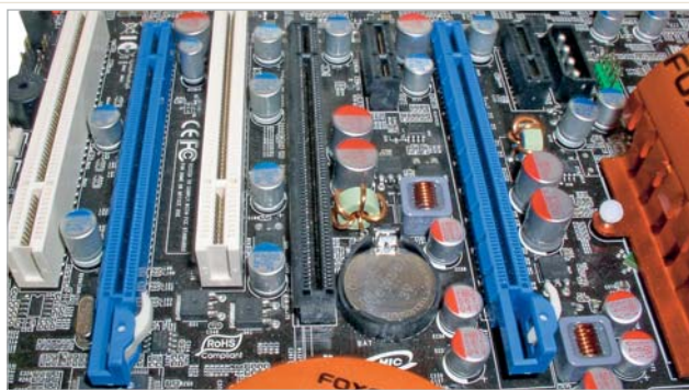
ВПЕРВЫЕ ДЛЯ CORE 2 появилась возможность использовать две видеокарты в SLI-режиме на чипе nForce 680i SLI. Аналогичное решение от Intel пока только ожидается
