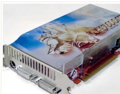
MSI NX7600GT-T2D256E отличается турбинным, более эффективным по сравнению с классическим, типом охлаждения
