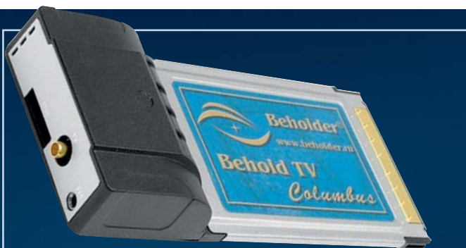
BEHOLD TV COLUMBUS является, по сути, PCMCIA-локализацией удачной модели PCI-формата Behold TV 409 FM и обладает таким же высоким качеством приема и набором дополнительных функций
