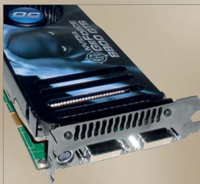
ВСЯ ПЛАТА СЕРИИ 8800 занимает два слота, в том числе и в версии 320 Мбайт
