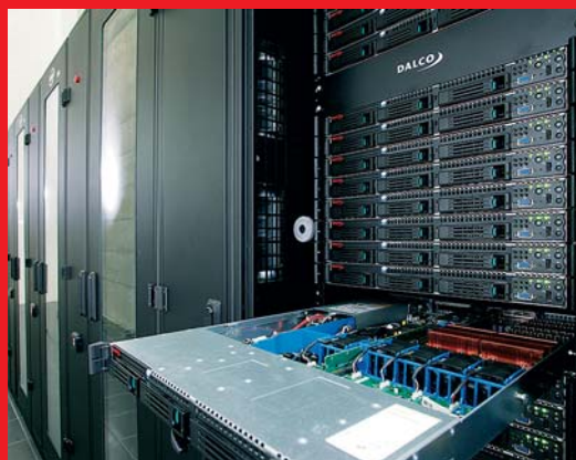
В компьютере Albert 2 используется 512 процессоров Intel Dual Core Xeon на 256 материнских платах (вверху). Под компьютером, где проходят также охлаждающие трубки, потоки данных поступают в интерконнект
