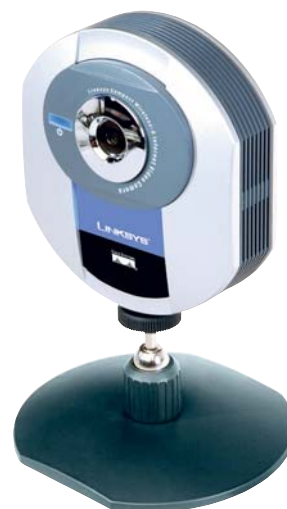
WVC54GC оснащена самой скромной матрицей, позволяющей передавать видео с разрешением 320x240 точек
