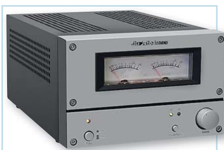
JB-391 До сих пор ни одни мультимедийные АС не могли похвастать столь проработанным и сложным усилителем. Даже в пассивном режиме БП потребляет немало энергии и ощутимо нагревается
