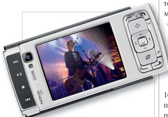
NOKIA N95 2,6-дюймовый TFT-дисплей (240x320 точек) с датчиком освещенности отображает 16 млн цветов
