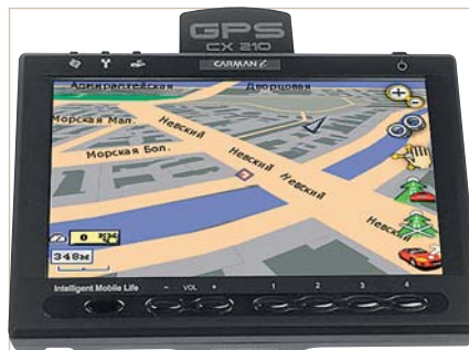
CARMANI CX210 воспроизводит мультимедиа, а также имеет AV-вход, к которому можно подключить даже видеокамеру
