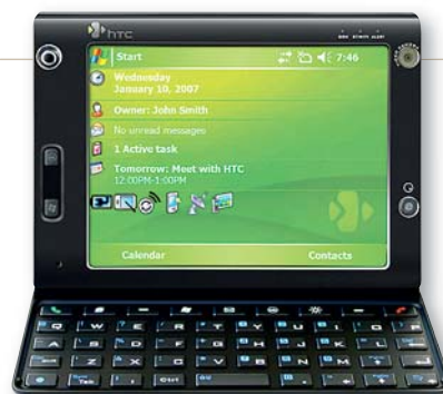
HTC ADVANTAGE X7500 TFT-дисплей отображает только 262 144 цвета, зато он обладает разрешением 640x480 точек
