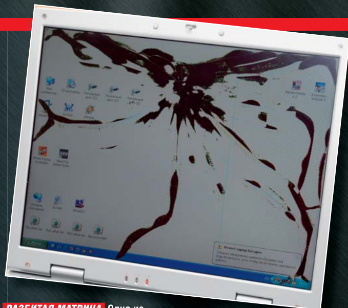
РАЗБИТАЯ МАТРИЦА Одна из самых дорогих и часто встречающихся неисправностей, ликвидация которой может стоить многие тысячи рублей. Иногда проще купить новый ноутбук
