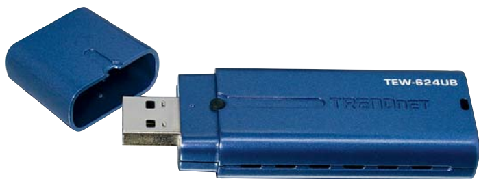
АДАПТЕР TEW-624UB поддерживает технологию MIMO с тремя встроенными печатными антеннами
