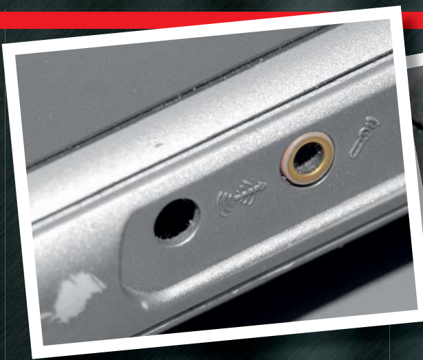
ВЫБИТЫЕ ПОРТЫ Неаккуратная вставка и извлечение коннекторов, а также небрежное обращение приводят к физическому повреждению портов и разъемов
