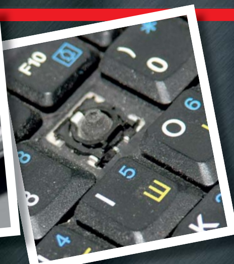
РАЗБИТАЯ КЛАВИАТУРА Дешевые ноутбуки зачастую оснащены не очень прочной клавиатурой, а стучать по ней любят многие пользователи. В результате необходима замена
