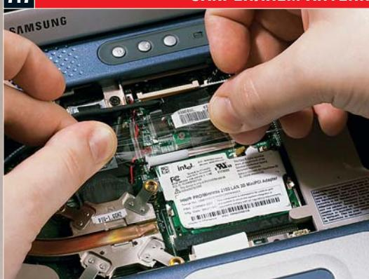
Закрепите антенну полоской обычной клейкой лентой таким образом, чтобы она не выходила из отведенного ей пространства и не могла случайно повредить окружающие компоненты.
