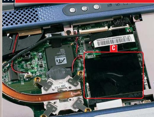
Теперь доступна вся внутренняя часть ноутбука. Слот mini PCI **C** для карты WLAN в нашем примере (Samsung P10) находится в правом нижнем углу — между процессором и жестким диском.
