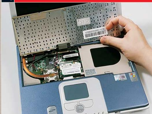
Теперь соберите обратно все части компьютера. Подключите кабель клавиатуры внутри ноутбука. В зависимости от модели, клавиатуру нужно вдавить обратно в защелки. Прижмите ее, переверните ноутбук, завинтите – и готово.
