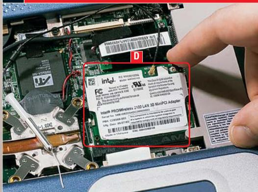
Возьмите в руки беспроводную карту **D** таким образом, чтобы разъем с обратной стороны модуля оказался над гнездом на материнской плате. Очень аккуратно вдавите модуль в слот mini PCI.
