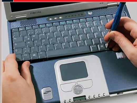
Переверните ноутбук и откройте дисплей. Для того чтобы снять клавиатуру, понадобится отвертка и аккуратность. Подцепите плоскими отвертками края клавиатуры и слегка потяните на себя: небольшое сопротивление защелок можно преодолеть легким нажатием на них.
