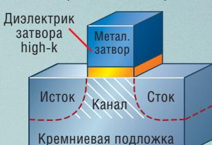
**ТРАНЗИСТОР** — своеобразный выключатель электрического тока, управляет током между двумя электродами при помощи третьего.
