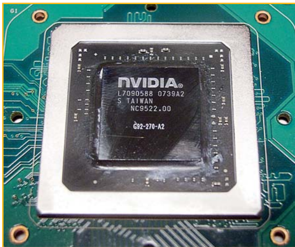
Чип G92 65-нм техпроцесс позволил уменьшить площадь кристалла до 324 мм 2 вместо 484 мм 2 у G80
