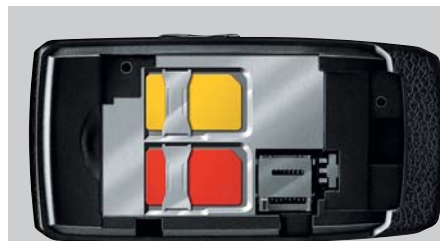
SAMSUNG D880 DUOS Под задней крышкой корпуса слайдера расположены слоты для двух SIM-карт
