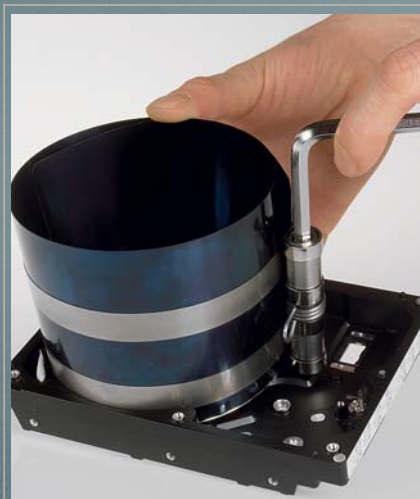
7 ПЕРЕУСТАНОВКА МАГНИТНЫХ ДИСКОВ Натяжное устройство поршневого кольца гарантирует, что положение дисков по отношению друг к другу не изменится
