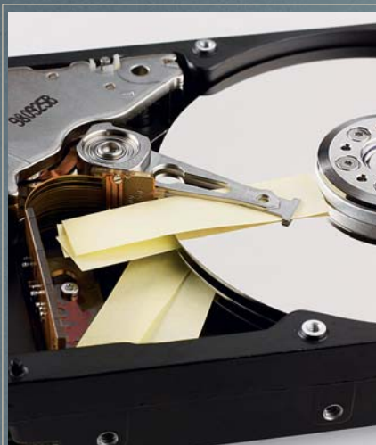
6 ЗАМЕНА СЧИТЫВАЮЩИХ ГОЛОВЕК При замене головок проложите между ними и магнитными дисками полоски бумаги, чтобы избежать соприкосновения
