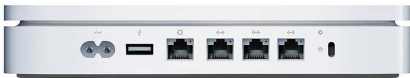
APPLE TIMECAPSULE Интересное устройство от инженеров из Купертино сочетает в себе маршрутизатор, точку доступа и сетевой накопитель с возможностью резервного копирования
