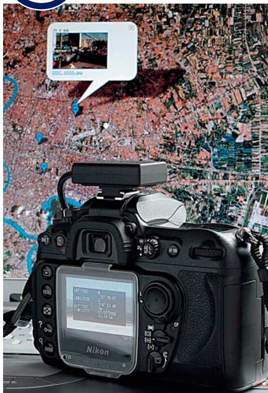
НА БАШМАК Специальные устройства для геотегинга стоят недешево и предназначены для работы с дорогими зеркальными камерами
