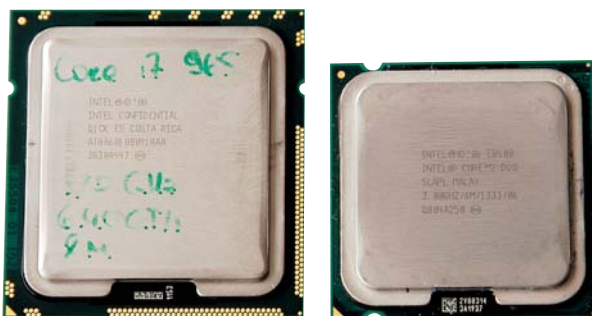
CORE I7 965 EXTREME EDITION (слева) в сравнении с Core 2 Duo E8400 (справа) — размер нового CPU заметно больше
