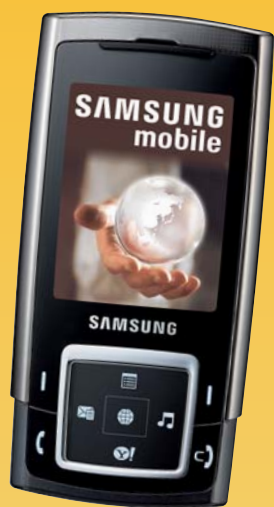
SAMSUNG SGH-E950 оснащен сенсорной OLED-панелью, предлагающей в зависимости от выполняемых задач различные кнопки-иконки
