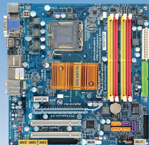
GA-E7AUM-DS2H — новая материнская плата от компании Gigabyte для процессоров Intel с достаточно мощным видеоядром NVIDIA GeForce 9400
