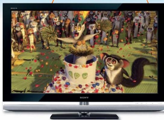
Sony удваивает частоту до 200 Гц: в спортивных передачах три дополнительные картинки должны обеспечивать ощущение более плавного движения. Однако при просмотре фильмов, сгенерированных компьютером, заметны паразитные эффекты: иногда кажется, что объекты «плавают».
