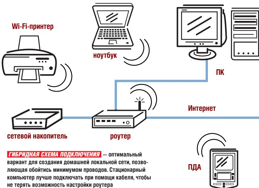
**ГИБРИДНАЯ СХЕМА ПОДКЛЮЧЕНИЯ** — оптимальный вариант для создания домашней локальной сети, позволяющая обойтись минимумом проводов. Стационарный компьютер лучше подключать при помощи кабеля, чтобы не терять возможность настройки роутера
