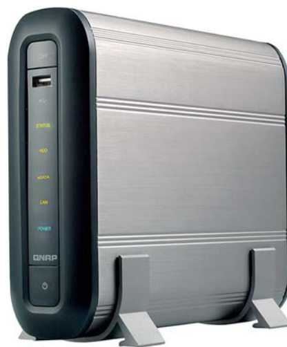
QNAP TS-109 работает бесшумно, но для создания хранилища повышенной надежности (RAID 1) нужен дополнительный внешний диск
