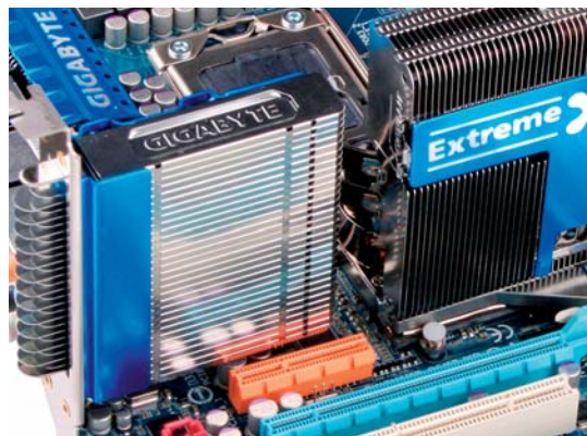
HYBRID SILENT-PIPE 2 — уникальная система охлаждения, установленная на плате Gigabyte GA-EX58-Extreme
