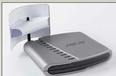
Съемная параболическая антенна фокусирует сигнал лучше, чем стандартная, от производителя. Это обеспечивает повышенную скорость передачи данных при прохождении радиоволн сквозь препятствия. Способ ее изготовления описан в CHIP №7 2009 в статье «Как повысить скорость WLAN».
