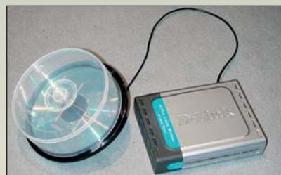
Используя всенаправленную антенну, созданную из обычного CD, упаковки для оптических дисков и проволоки, можно получить выигрыш в мощности порядка 10 дБ для старых маршрутизаторов. Увы, современные модели стандарта 802.11n не будут работать с подобной антенной.
