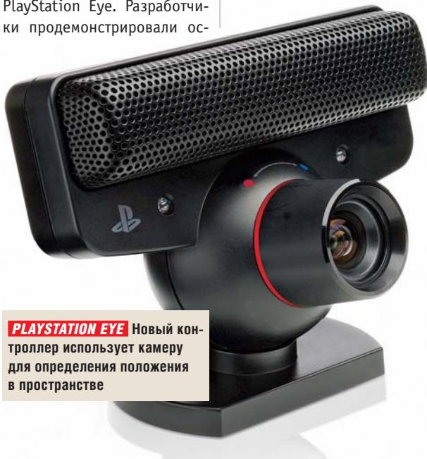
**PLAYSTATION EYE** Новый контроллер использует камеру для определения положения в пространстве
