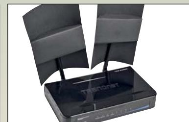
Для устройства с двумя антennами входами можно смонтировать двойную параболическую антенну из картона, обклеенного фольгой. Она будет излучать сфокусированный сигнал в одном направлении. Подробную инструкцию по изготовлению вы найдете на сайте [www.freeantennas.com](http://www.freeantennas.com).
