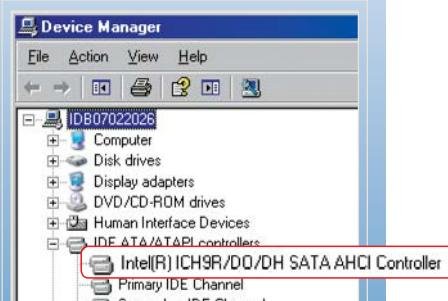
**1 РЕЗУЛЬТАТ** В случае правильной замены драйвера AHCI-контроллеры должны быть корректно определены системой
