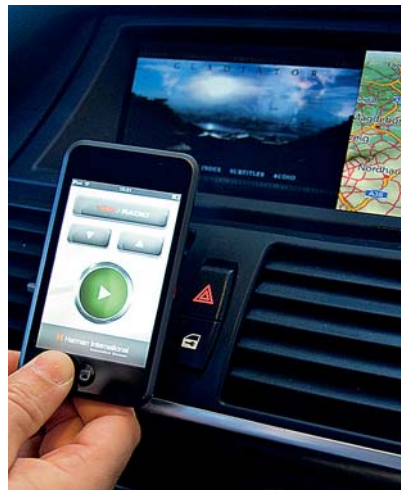
ЭЛЕГАНТНЫЙ ПУЛЬТ ДУ Магнитолой бортового компьютера, построенного на базе Atom, можно комфортно управлять с заднего сидения с помощью iPod Touch
