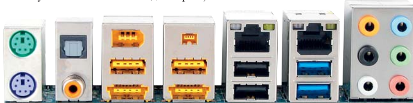
ДВА ПОРТА USB 3.0 на задней панели можно распознать по пластмассовым вставкам синего цвета
