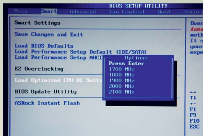
ASROCK ION 330-BD позволяет регулировать скорость вращения вентилятора и частоты процессора и видеоядра из BIOS Setup
