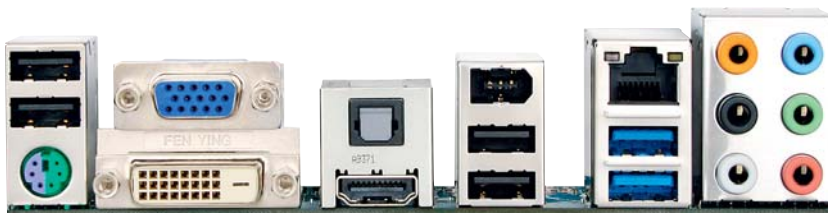
ВИДЕОВЫХОДЫ VGA, DVI и HDMI позволяют подключить к плате практически любое устройство отображения информации
