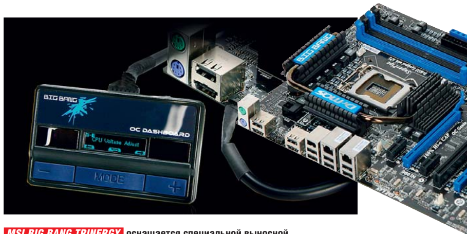
MSI BIG BANG TRINERGER оснащается специальной выносной панелью, упрощающей процедуру разгона
