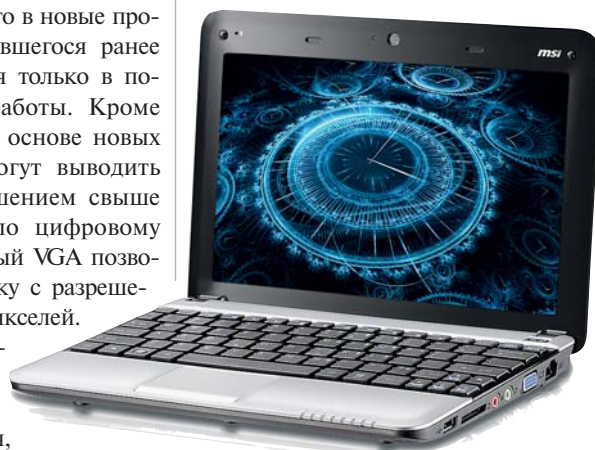
НЕТБУК MSI WIND U135 на платформе Pine Trail проработал в автономном режиме более шести часов
