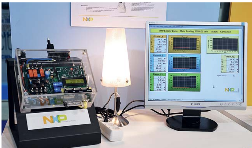
ПРОТОТИП ИНТЕЛЛЕКТУАЛЬНОГО ЭЛЕКТРОСЧЕТЧИКА , разработанный специалистами компании NXP Semiconductors, позволяет в режиме реального времени отслеживать основные параметры электрической сети, выводить их на монитор и передавать на диспетчерский узел
