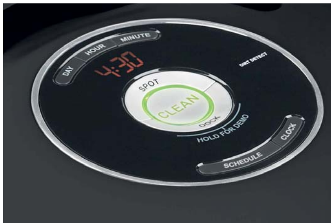
График уборки Старшие модели Roomba могут начать работу автоматически в указанные вами день и время. Для программирования на корпусе предусмотрены дополнительные кнопки
