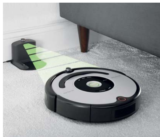
Док-станция По завершении уборки робот сам определяет местоположение док-станции с помощью инфракрасного датчика и возвращается на нее
