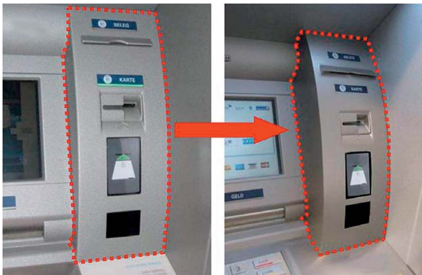
Незаметное решение Вместо установки нескольких дополнительных устройств преступники могут использовать накладную панель с интегрированными считывающими устройствами
