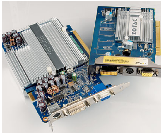
Пассивное охлаждение Безвентиляторные видеоплаты абсолютно бесшумны, но, несмотря на это, позволяют играть в игры
