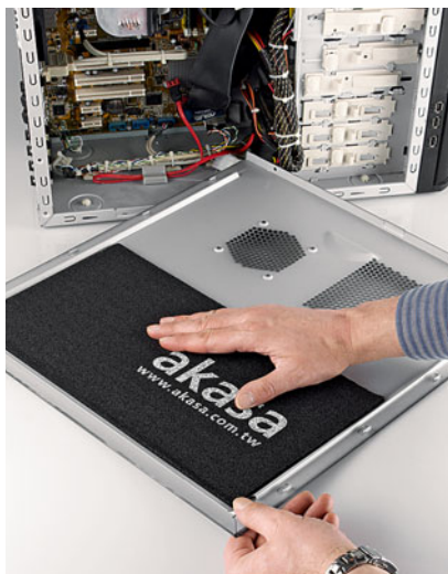
Звукоизоляция корпуса Тщательно расправьте звукоизоляционную панель и следите за тем, чтобы не перекрыть вентиляционные отверстия
