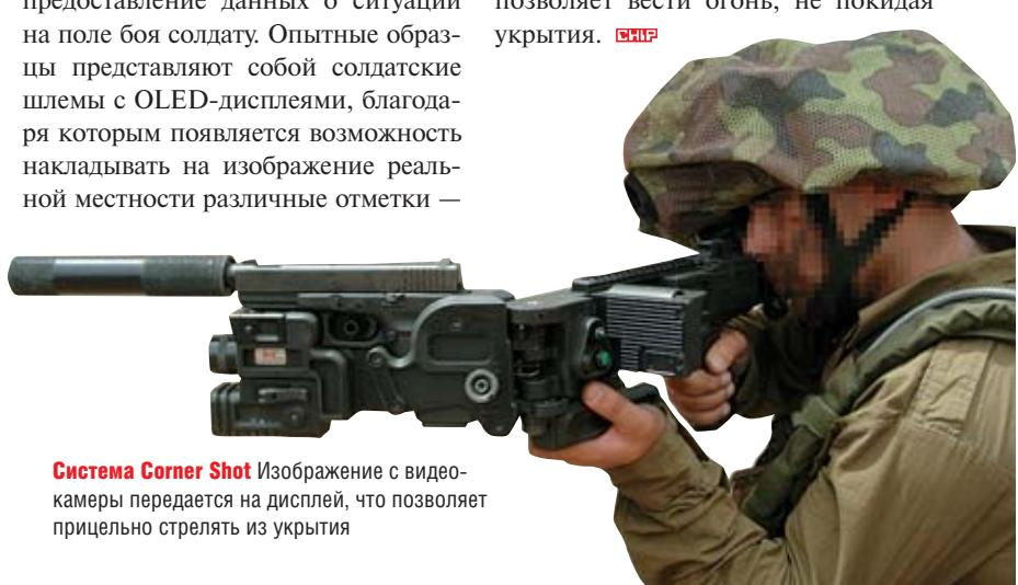
**Система Corner Shot** Изображение с видеокамеры передается на дисплей, что позволяет прицельно стрелять из укрытия
