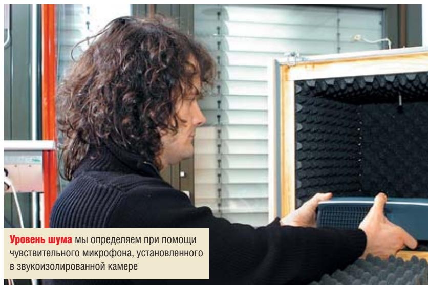
При тестировании внешних накопителей CHIP проверяет не только их быстродействие, но и другие важные характеристики. В частности, шумность особенно критична для настольных 3,5-дюймовых моделей, а для переносных накопителей формата 2,5 дюйма весьма актуальны компактные размеры и отсутствие лишних кабелей.
