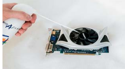
Очистка видеокарты. С помощью баллона со сжатым воздухом вы быстро и без усилий избавитесь от пыли
