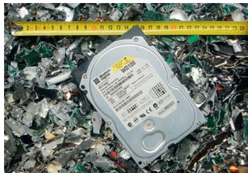
Шредер для HDD Вычислительные центры уничтожают старые винчестеры механическим способом
