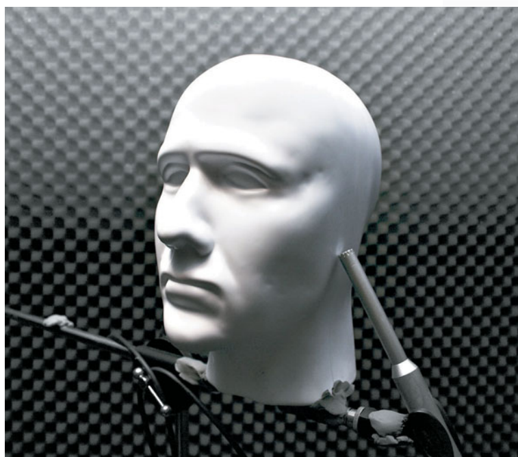
Макеты головы со встроенными микрофонами используются для записи бинаурального аудио, при прослушивании обладающего эффектом объемного звука
