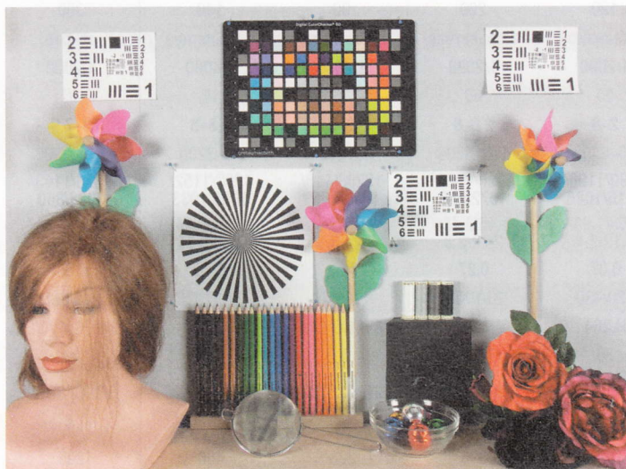
Тест fotocувствительности Основной целью этой проверки является измерение шумов, а также неточности в передаче цветовых оттенков
