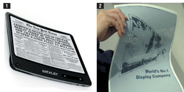
WEXLER. Flex ONE 1 — первая в мире электронная книга на основе гибкого экрана E-Ink, имеющая шестидюймовый дисплей. Компания LG представила дисплей такого типа размером более 10 дюймов 2
