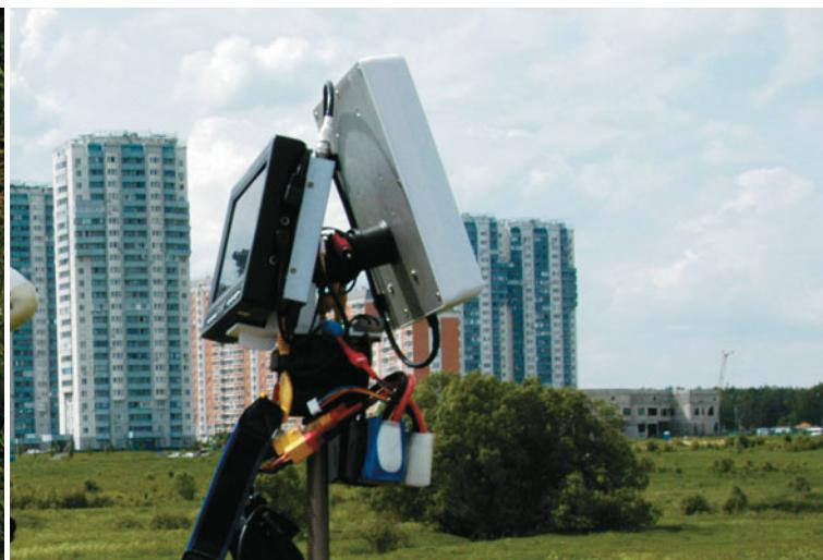
На фотоштативе закреплены направленная антенна, телевизор, конвертер видеосигнала, передатчик для очков и аккумуляторы
