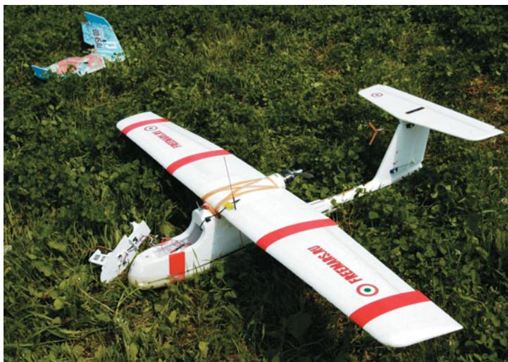
Модель на заднем плане изготовлена из пеноплата ЕРО, и ее очень сложно разбить. Skywalker в центре выполнен из ЕРР
