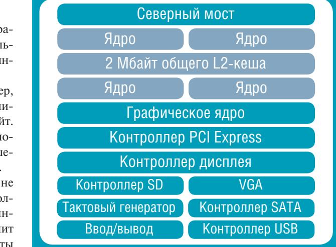
Процессоры AMD с архитектурой Jaguar оснащены различными встроенным контроллерами
