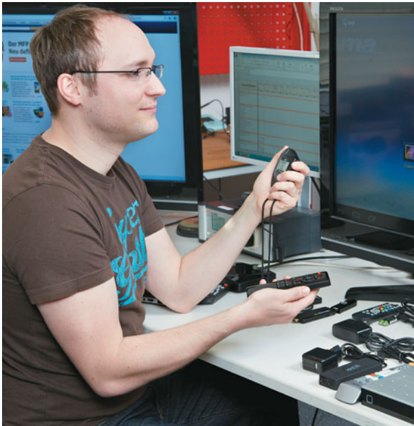
Сотрудник лаборатории CHIP измеряет время загрузки тестовой страницы бенчмарка SunSpider
