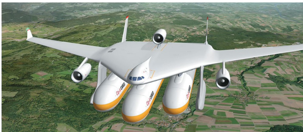
Clip-Air — гибридный самолет и поезд. Под его крылом может разместиться три капсульных вагона общей вместимостью в 450 пассажиров
