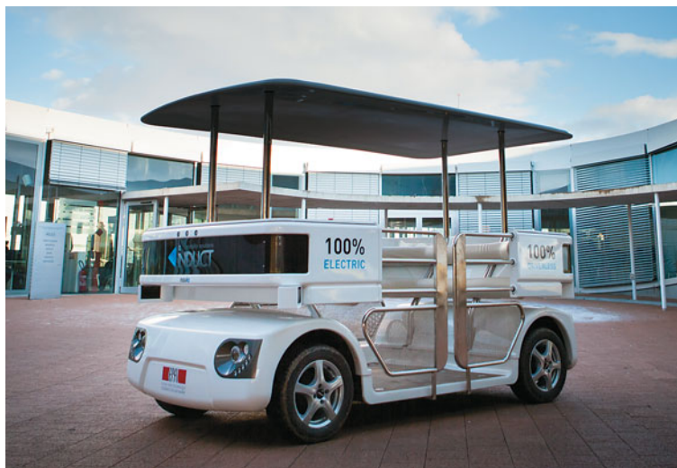
Роботизированные автобусы Navia способны на безопасную перевозку пассажиров по заданному маршруту без водителя
