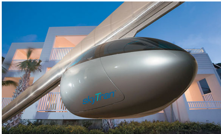
Пассажирская капсула системы Skytran передвигается по специальной рельсе, от которой запитывается электричеством
