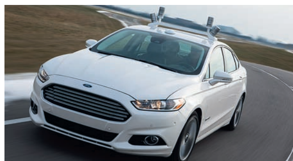
Ford испытывает автономную версию гибридной модели Fusion, которая сканирует окружающее пространство с помощью лазерных датчиков на крыше
