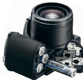
В фотокамере Nikon Coolpix L830 достаточно места для четырех пальчиковых аккумуляторов, поэтому у нее рекордные показатели в тесте продолжительности автономной работы
