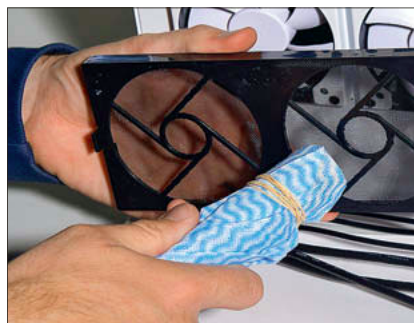
Модульный фильтр Полезная деталь корпуса — фильтры на воздухозаборниках, которые при необходимости легко чистятся пылесосом
