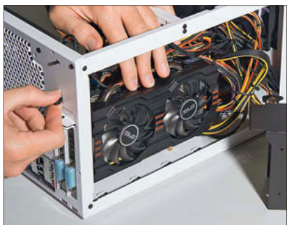
Место для видеокарты При демонтаже одного из контейнеров для приводов в корпусе Fractal Design Node 304 освободится место для видеокарты увеличенного размера
