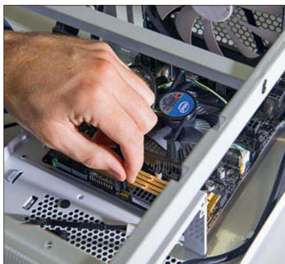
Установка материнской платы Достаньте контейнер HDD, закрепите материнскую плату, потом установите на нее процессор, а затем — кулер
