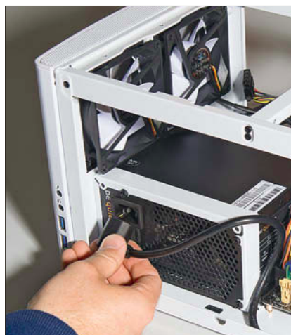
Установка блока питания После монтажа материнской платы закрепите блок питания при помощи трех винтов и подключите кабель питания
