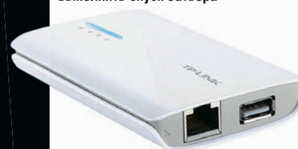
Роутер TP-LINK TL-MR3040 может выступить в роли Wi-Fi-адаптера для фотокамеры
