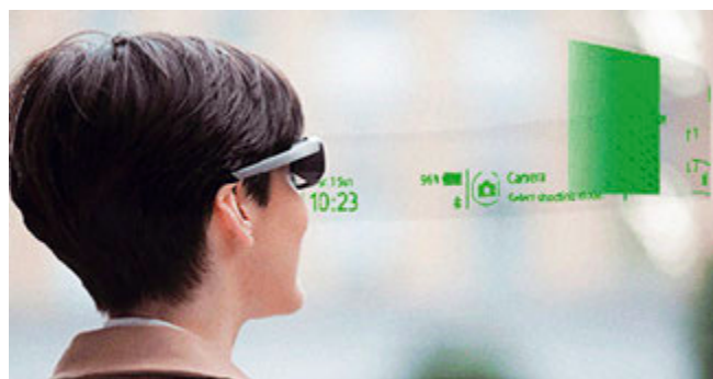
Устройство Sony SmartEyeglass высвечивает информацию только зеленым шрифтом. Дисплей Google Glass поддерживает больше цветов
