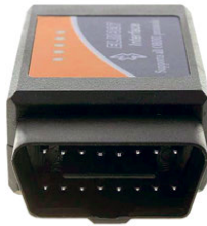
Диагностический модуль имеет 16-контактный разъем, стандартный для большинства марок автомобилей
