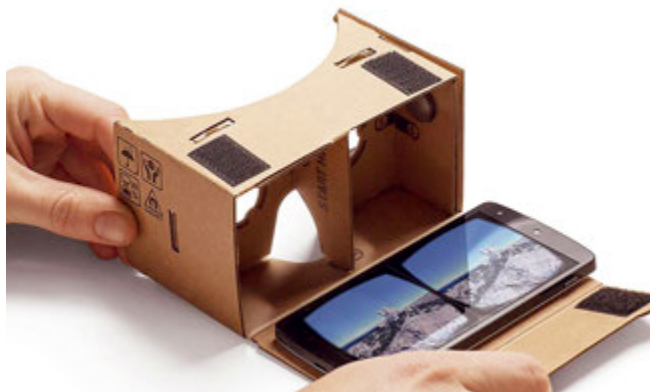
Проект Google Cardboard — это очки виртуальной реальности для любителей мастерить своими руками. Схему и список нужных материалов для сборки крепления для очков виртуальной реальности из картона можно найти на странице google.com/get/cardboard
