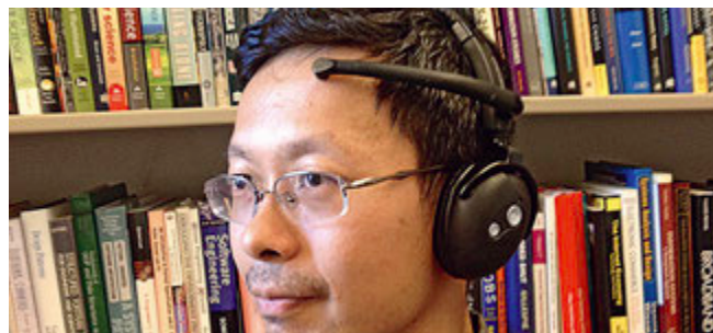
С помощью специальной гарнитуры исследователи считывают волны, генерируемые мозгом. Как только пользователь подумает об определенной вещи, устройство передаст код активации на компьютер.
