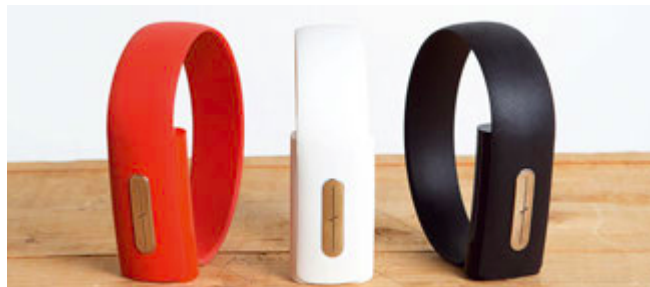
Браслет Nymi определяет расположение сердечной мышцы и частоту сердечных сокращений. В настоящее время его разработка продолжается, а выход на рынок ожидается в 2015 году.
