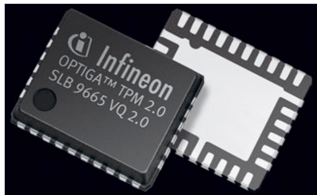
Смартфоны с операционной системой Windows Phone 8 и старше оснащаются специальным чипом стандарта TPM 2.0, предназначенным для хранения ключей шифрования устройства
