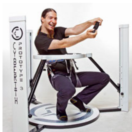
«Беговая дорожка» Cyberith Virtualizer переносит движения в виртуальную реальность. Игрок может бежать по ровной поверхности, физически не двигаясь с места
