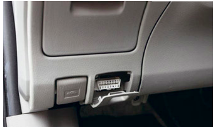
Подключение сканера кодов OBD2 осуществляется через колодку, расположенную в большинстве случаев в салоне авто под приборной панелью
