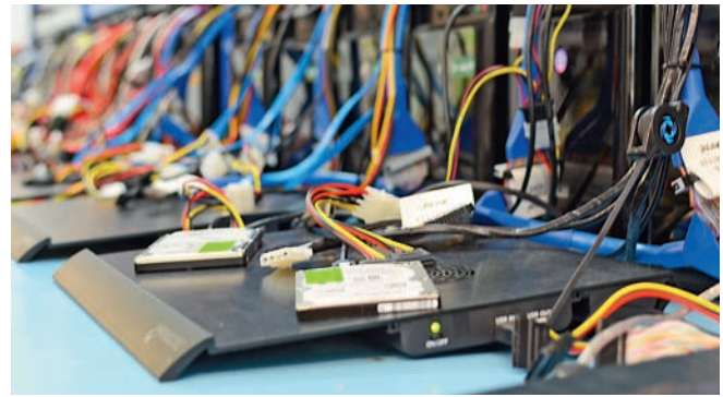
Считывающая станция Kroll Ontrack может создавать образы десятков жестких дисков одновременно
