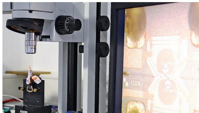
В микроскоп видно, что считывающие головки (справа) смещены. Это нужно учитывать при чтении диска
