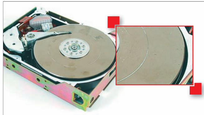
Жесткий диск с поврежденной головкой вскрывается для спасения данных с неповрежденных дорожек
