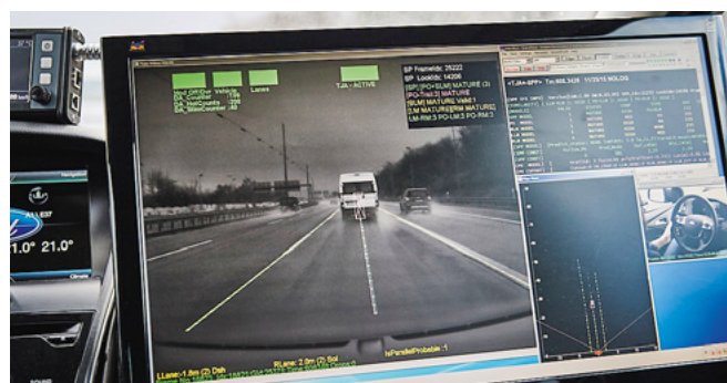
Благодаря фронтальной камере за лобовым стеклом система Traffic Jam Assist удерживает автомобиль по центру полосы
