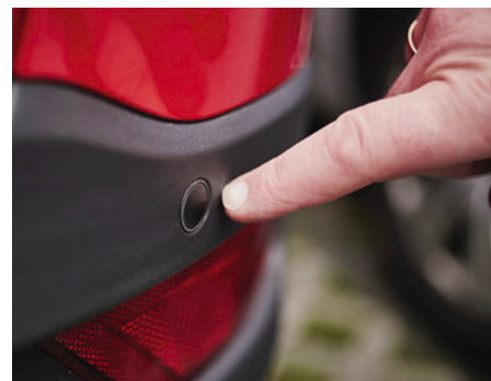
Ультразвуковые сенсоры встроены в кузов автомобиля спереди и сзади.
