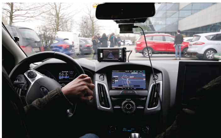
Благодаря фронтальной камере за лобовым стеклом система Traffic Jam Assist удерживает автомобиль по центру полосы
