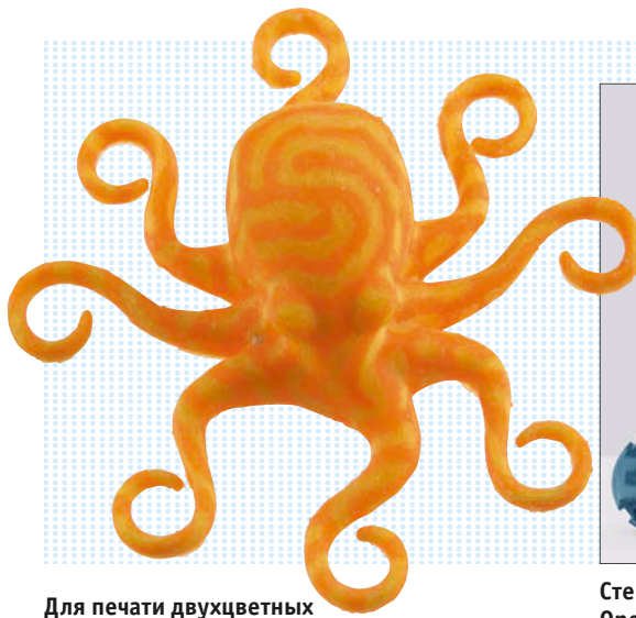
Для печати двухцветных элементов необходимы два экструдера, как, например, в модели Leapfrog Creatr
