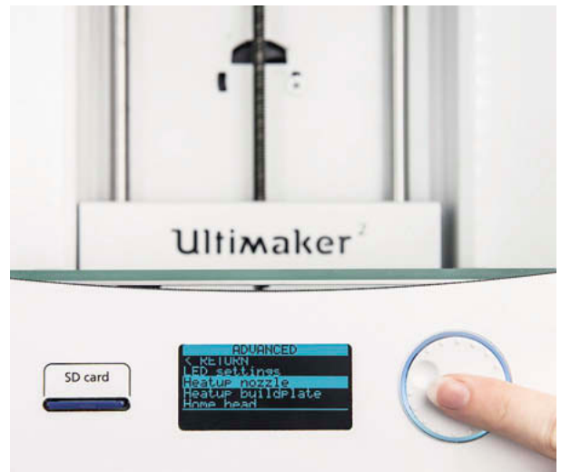
Дисплей (представлен на примере модели Ultimaker 2) предназначен для изменения параметров основных настроек и отображает данные о процессе печати
