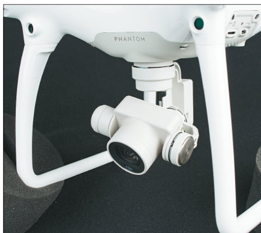
Стабилизирующий подвес Автоматический подвес камеры DJI Phantom 4 выравнивает все движения и колебания дрона
