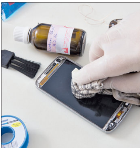
Советы по проведению работ Работы с растворителем выполняйте в перчатках и в помещении с хорошей вентиляцией. Проворачивающиеся винты поддерживайте пинцетом. Извлекайте аккумулятор, не изгибая его, изолированным инструментом
