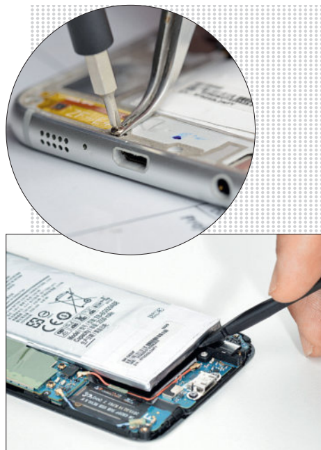
Советы по проведению работ Работы с растворителем выполняйте в перчатках и в помещении с хорошей вентиляцией. Проворачивающиеся винты поддерживайте пинцетом. Извлекайте аккумулятор, не изгибая его, изолированным инструментом
