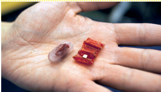
Робот-«оригами», созданный в Массачусетском институте, разворачивается в желудке или кишечнике; управление и перемещение осуществляется с помощью внешнего магнитного поля
