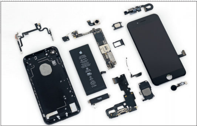
Многие компоненты iPhone 7 можно заменить по отдельности, что является плюсом. Однако части данной модели соединены клеем
