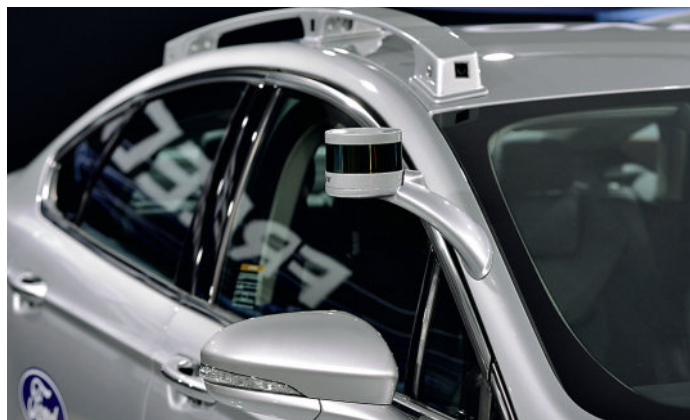
Новые датчики LiDAR получили большее поле обзора, что позволяет использовать всего два сенсора, а не четыре, как раньше
