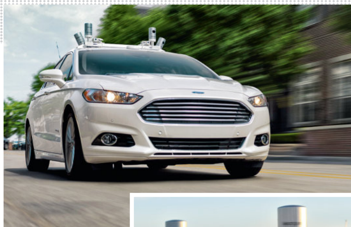
Умные датчики С помощью системы ночного видения автономный Ford Fusion Hybrid может передвигаться даже в абсолютной темноте
