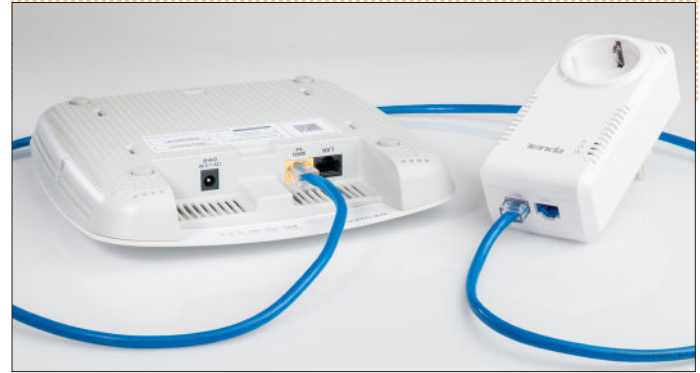
При помощи технологии Powerline точка доступа может обеспечить беспроводной сетью другой этаж или другую часть дома
