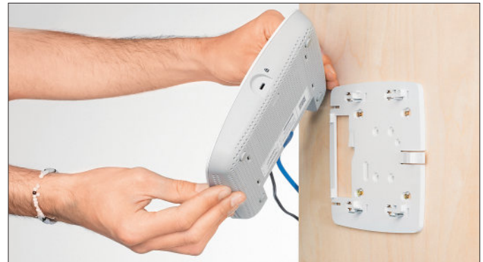
В комплект профессиональной точки доступа входит крепление, которое позволяет установить ее на потолок, стену или шкаф
