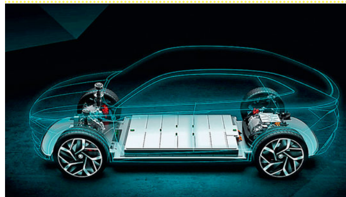
Полный привод и два электромотора на базе платформы MBE обеспечивают Vision E достаточной мощностью и запасом хода
