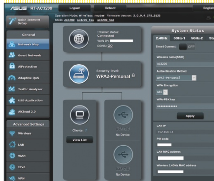
На веб-интерфейсе маршрутизатора с поддержкой Tri Band (здесь ASUS) можно отвести беспроводную сеть только для потока HD
