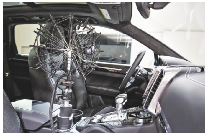
Так выглядит акустическая измерительная система, используемая Porsche для анализа всех шумов в салоне автомобиля
