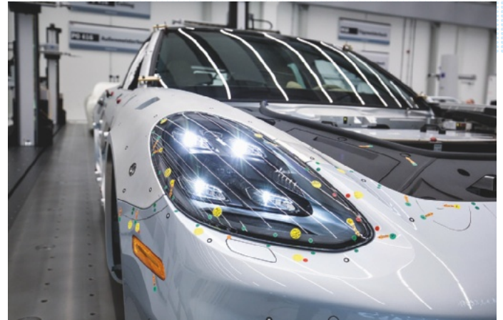
Вот так выглядят наклейки, отмечающие малейшие отклонения от эталона. С дополненной реальностью они скоро не понадобятся
