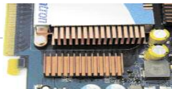
На грани между модой и необходимостью: радиаторы на чипах памяти
