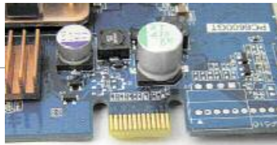
Разъем для SLI-моста плат nVidia неназойливо намекает на покупку «парной» карты
