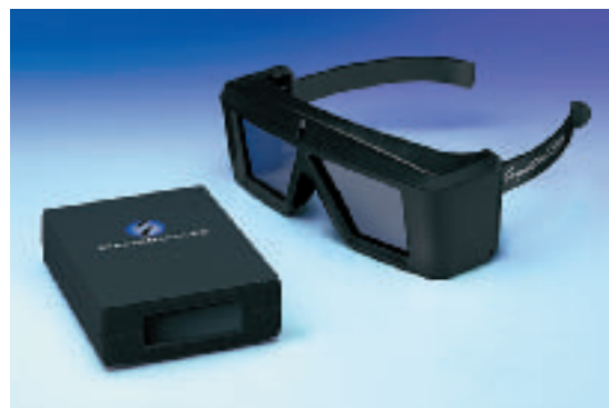
Совсем как кинопроектор, ЖК-прерыватели отсчитывают кадры, которые положено видеть каждому глазу
