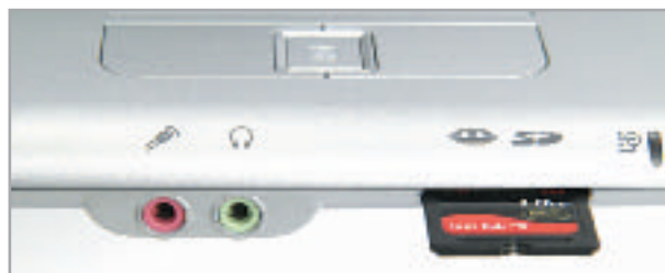
Аудиоразъемы и кард-ридер SD/MS на Samsung X25 повышают эргономику устройства, облегчая доступ к часто используемым интерфейсам
