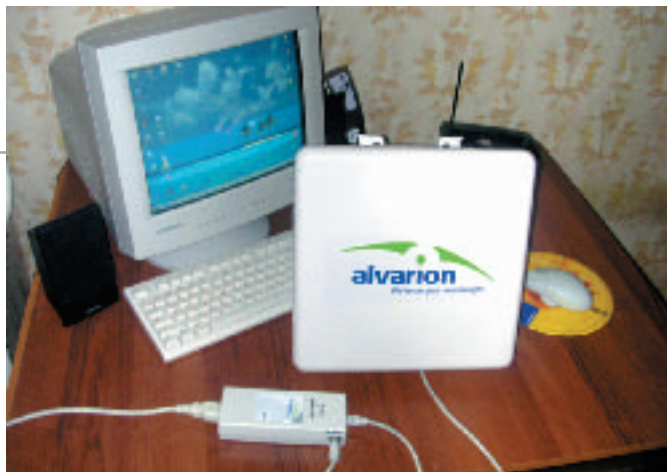
Абонентский терминал — это два устройства: ODU (антенна) и IDU (блок с Ethernet-интерфейсами)
