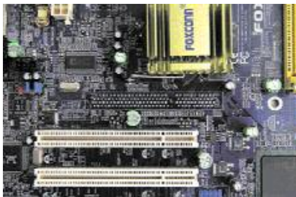
Отсутствие на плате графического разъема полностью исключает возможность апгрейда видеоподсистемы компьютера
