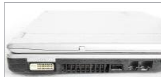
Версия Argo 45W имеет не только VGA-порт для подключения внешнего монитора, но и пока еще редкий DVI
