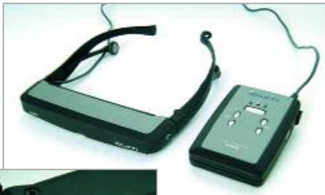
Каждый окуляр очков оснащен своим движком фокусировки
