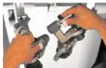
Для управления хирургическим инструментом врач использует специальные джойстики
